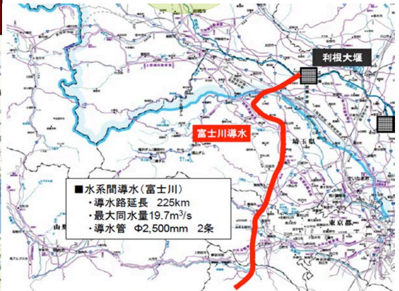
図 4-3-49 利水対策案の概要 ケース2-1 (藤原ダム掘)
